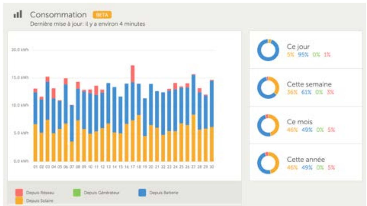
Chaque installation est équipée d'un monitoring permettant à SYSTEKO d'avoir un contrôle et les informations du site à distance. Ces informations sont également accessibles à l'utilisateur en toute transparence. Cela lui permet d'avoir une vision instantanée de sa consommation (grâce à l'écran de contrôle sur l'armoire), de stimuler et faciliter la démarche de maîtrise de l'énergie. Ces informations sont disponibles à partir d'un smartphone, d'une tablette ou d'un ordinateur.
